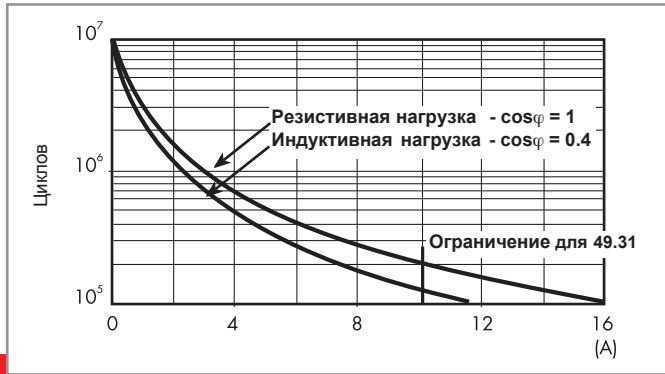
F 49 - Электрическая долговечность (АС) при ном. нагрузке, Типы 49.31/61/81
