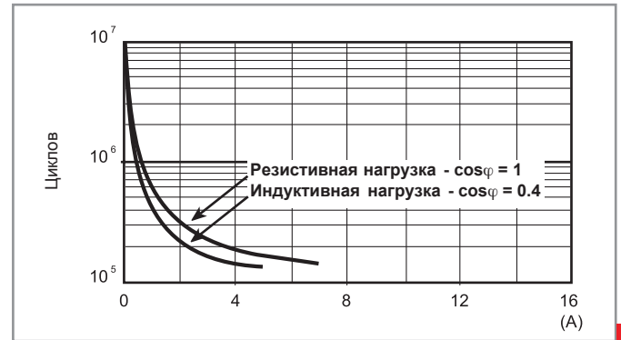
F 59 - Электрическая долговечность (AC) при ном. нагрузке, Реле с 4 перекидными контактами
