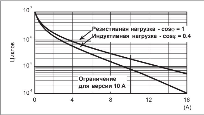
F 40 - Электрическая долговечность (AC) при ном. нагрузке Типы 40.11/41
