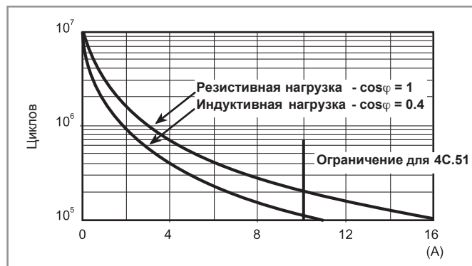
F 4C - Электрическая долговечность (AC) при ном. нагрузке, Типы 4C.01/51
