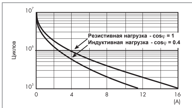
F 45 - Электрическая долговечность (AC) при ном. нагрузке тип 45.71
